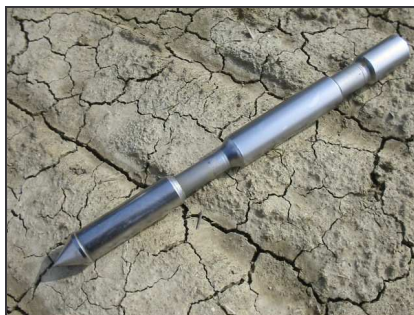
FIGURA 14.1: Punta telescopica tipo “Begemann”
