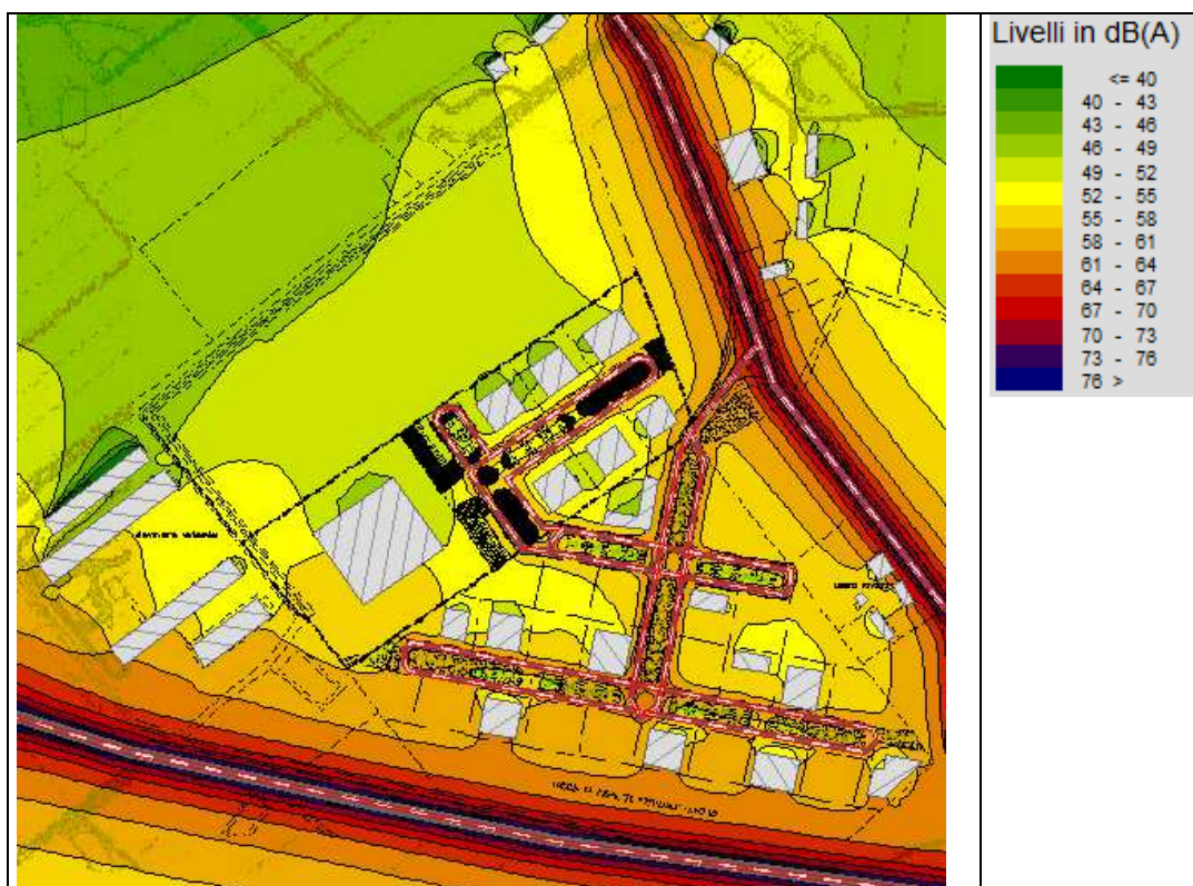
Figura 5 – Distribuzione dei livelli sonori diurni post-operam
